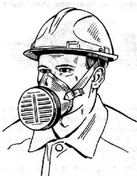
Рис. 3. Противопылевый респиратор Ф-62Ш
