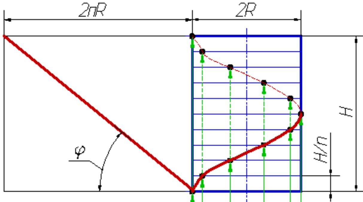
$\varphi$  - угол подъема винтовой линии
