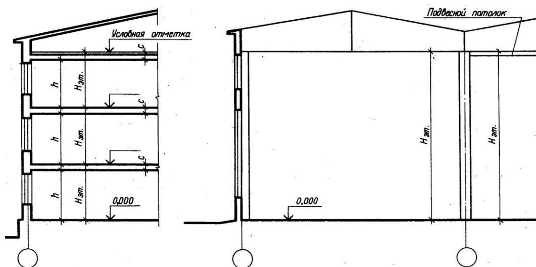
Размеры шагов, пролетов и высот этажей должны приниматься равными укрупненному модулю. Размеры конструктивных элементов должны быть кратными основному модулю.
