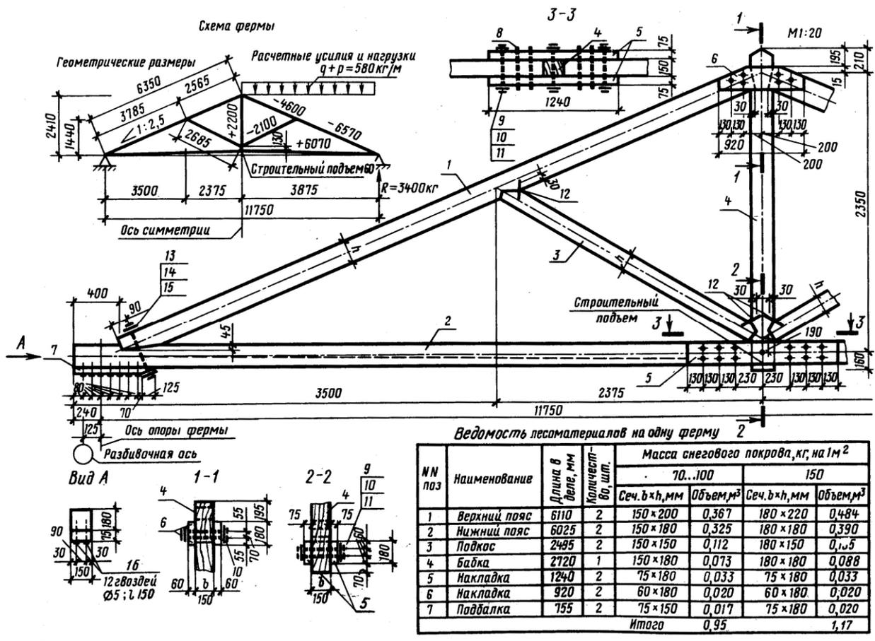
Применяют также **деревометаллические фермы**, в которых растянутые элементы выполняют из металла. Металлические элементы вычерчивают по правилам изображения металлических конструкций. При маркировке **деревометаллических конструкций** марки **деревянных элементов** обозначают буквой **Д**, а **металлических** – буквой **М**. Ведомость элементов обычно выполняют **раздельно** для **деревянных и металлических элементов**.
