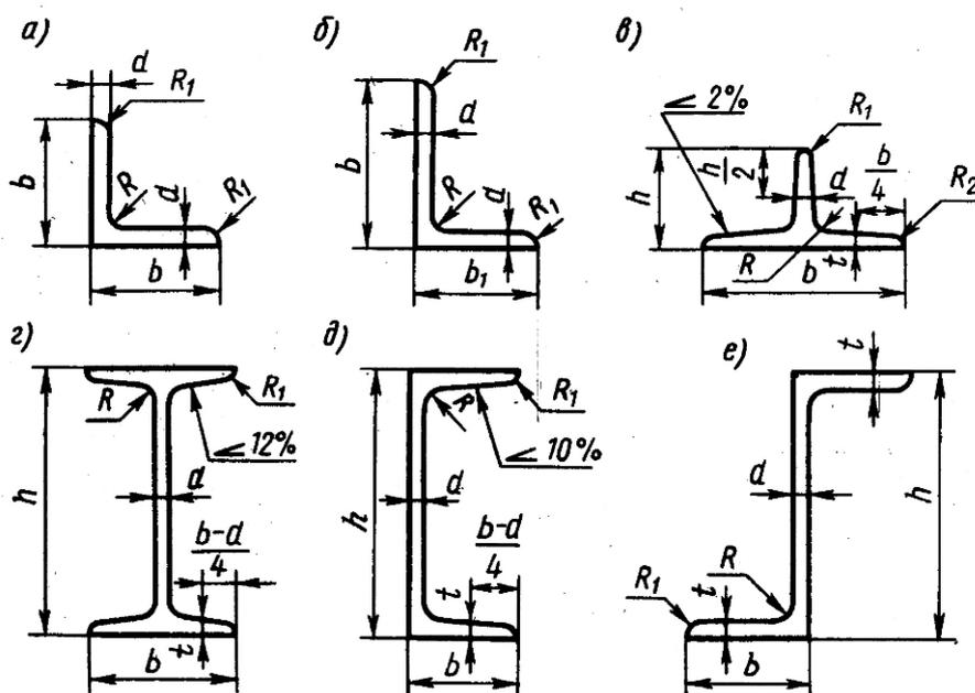
Элемент, определяемый величиной  $b$ , называется *полкой*, вертикальные элементы, определяемые величиной  $h$ , называются *стенкой*. Численное значение этих элементов зависит от номера проката и приводится в справочниках и ГОСТах на стальной прокат (сортамент). Номер профиля соответствует размеру полки или стенки в см.
