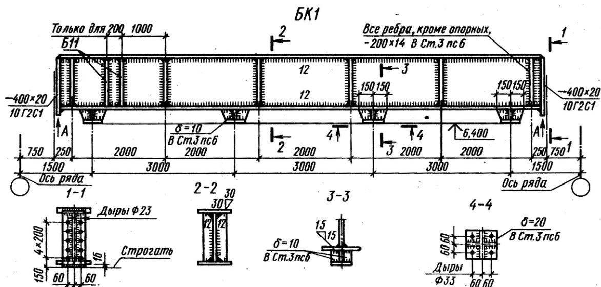
На **чертежах узлов** металлических конструкций изображают узлы отдельных элементов конструкции и узлы примыкания элементов конструкции друг к другу. На чертежах узлов наносят: привязочные размеры (до оси элементов, от торцов раскосов и стоек до точки пересечения их осей), толщины фасонки, приводят данные о креплении элементов (диаметры отверстий и болтов, типы и размеры сварных швов).
