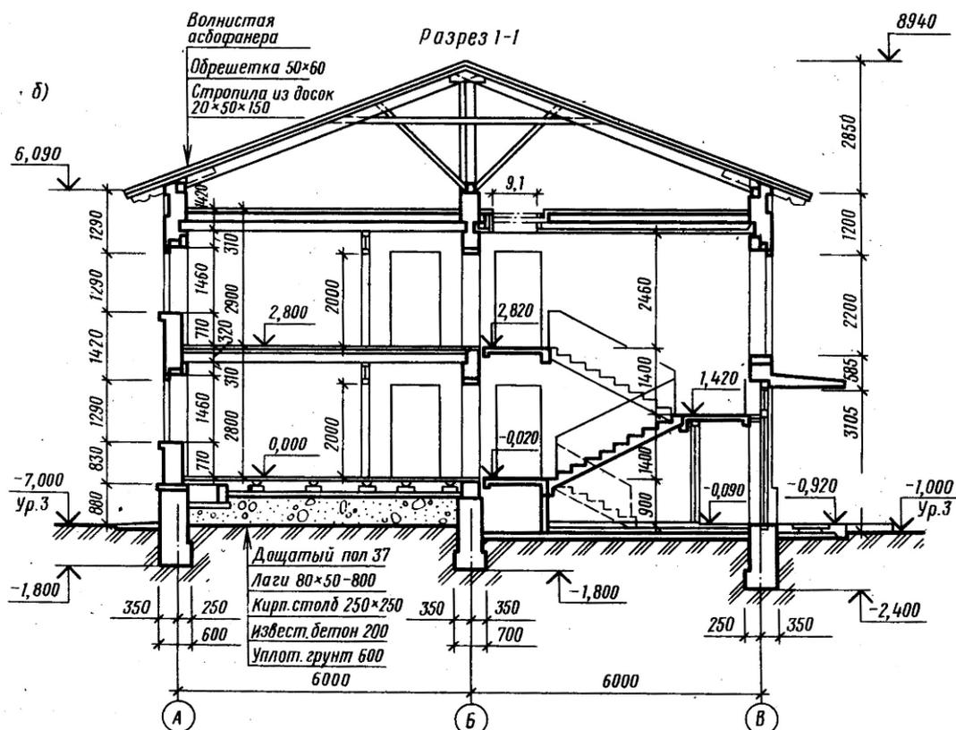
На разрезах координационные оси выносят вниз, маркируют и проставляют размеры между смежными осями.
