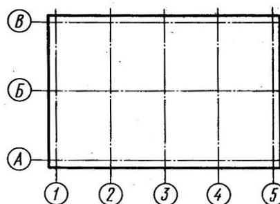
В зданиях с несущими продольными и поперечными стенами **привязку к координационным осям** наружных и внутренних стен производят следующим образом:
