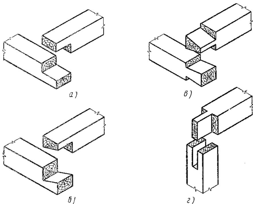
а) вполдерева; б) полулапой; в) простой лапой; г) прорезным прямым шипом
