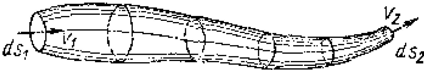
Элементарная струйка характеризует состояние движения жидкости в данный момент времени  $t$ . При установившемся движении элементарная струйка имеет следующие свойства:
