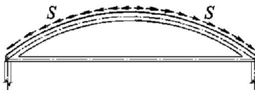
Рисунок 9.9. Схема передачи усилий с оболочки на диафрагму
