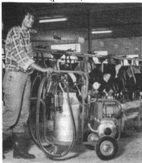
Рис. 20. Mobimelk — мобильная установка для доения в ведро, ООО «Вестфалия Сёрдж»
