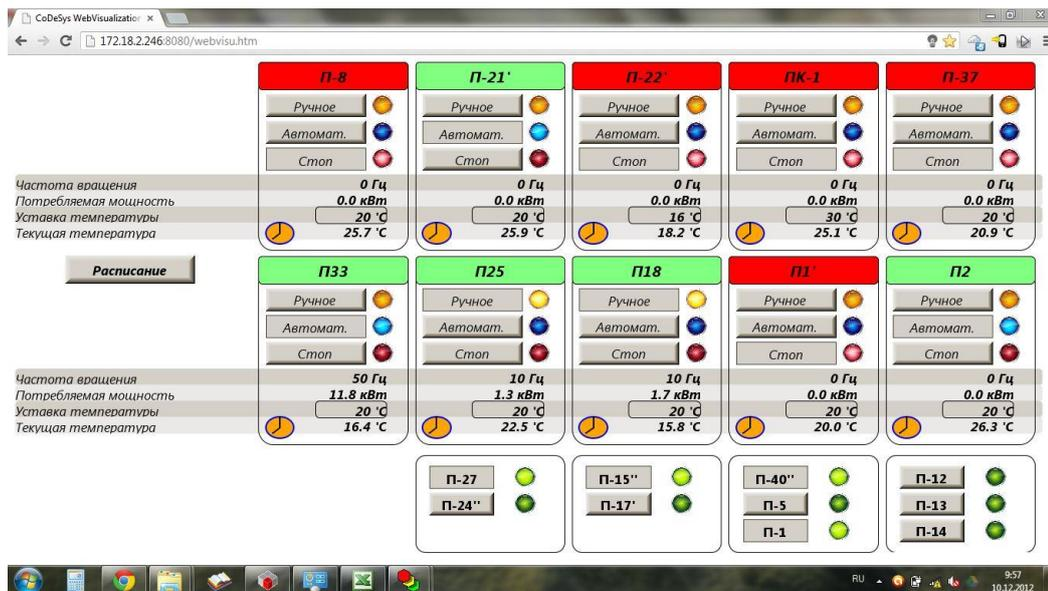
Рисунок 3. Дистанционное управление контроллером TRM133M
