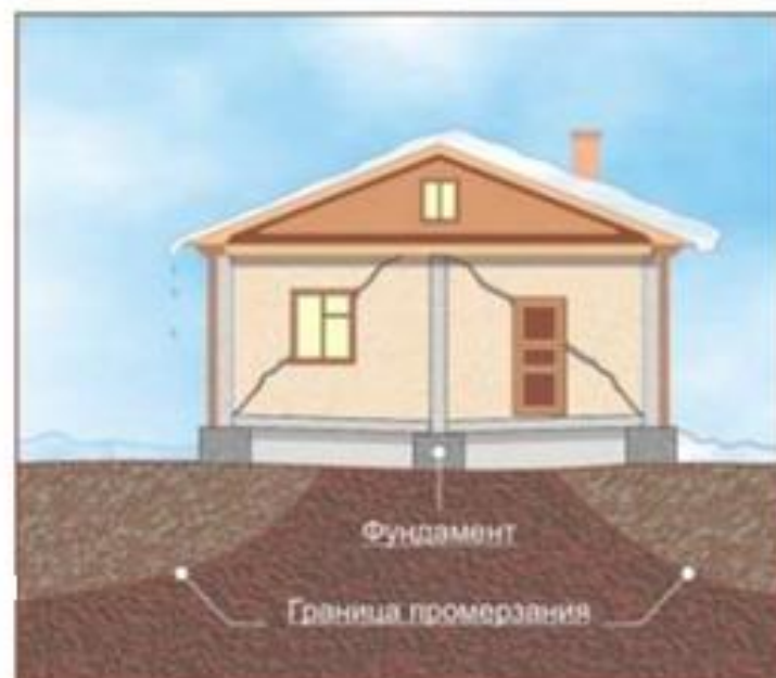
Деформация дома на пучинистом грунте
