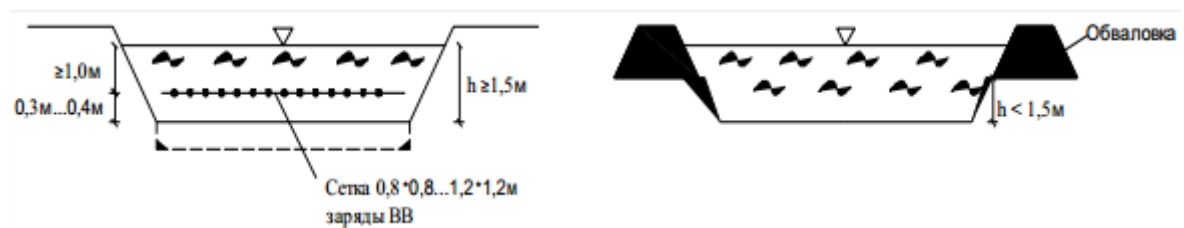
Рис. 4.10. Схема уплотнения рыхлых песчаных грунтов подводными взрывами
