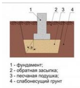
Рис. 4.1. Устройство песчаной подушки, заменяющей слабый грунт
