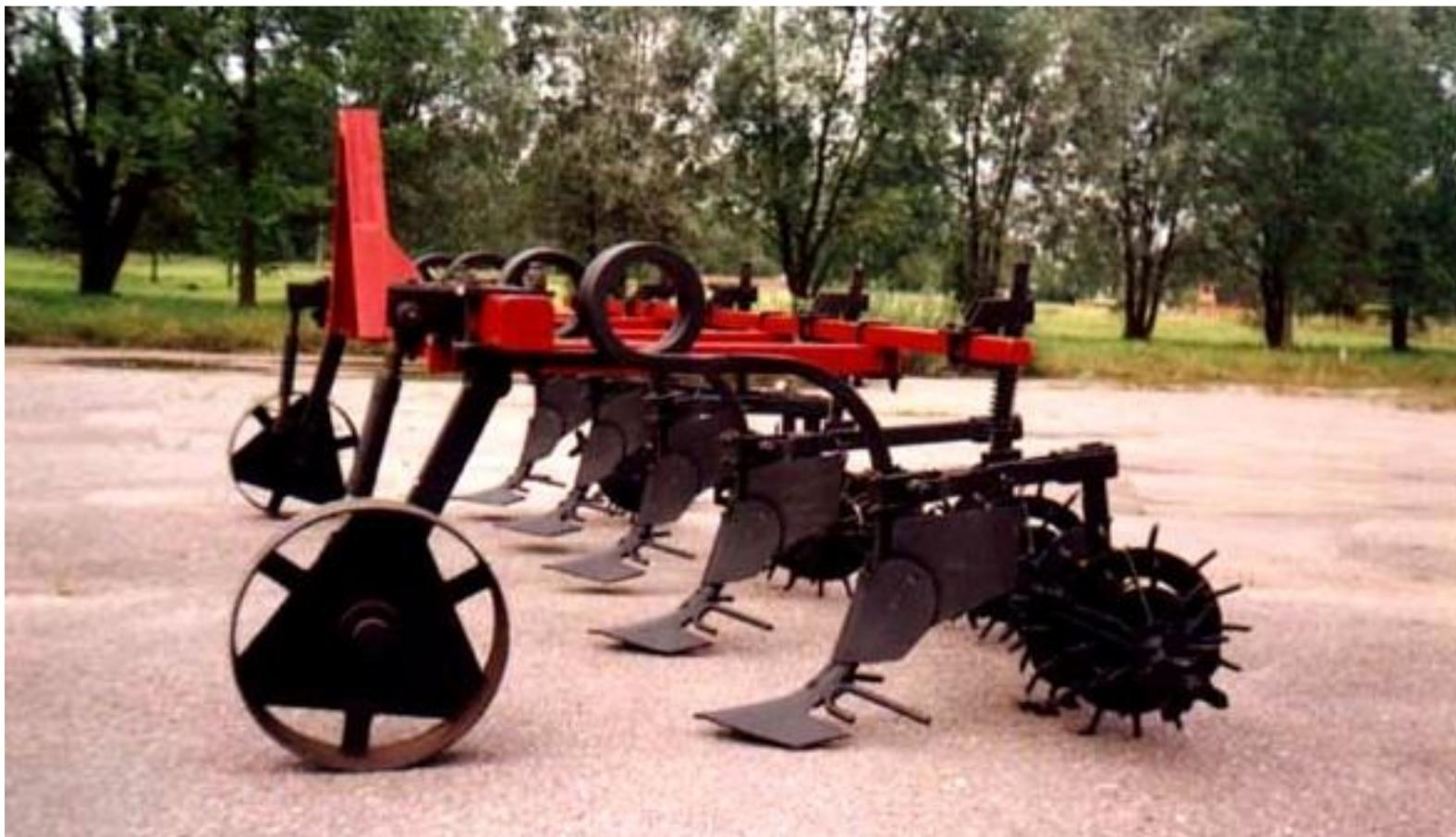
**Чизелевание.** Обработка с помощью чизельных орудий - обеспечивает рыхление и частичное перемешивание почвы на глубину 20-40 см.
