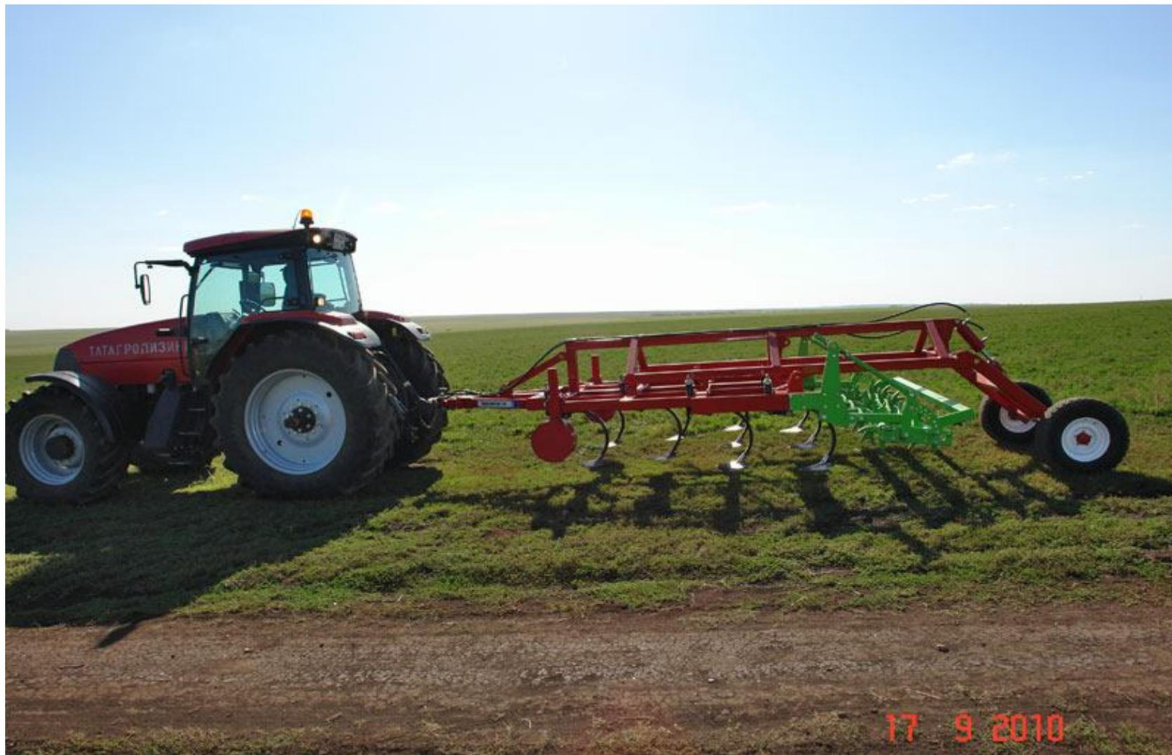
**Плоскорезная обработка** - безотвальная обработка почвы плоскорезными орудиями с сохранением большей части пожнивных остатков, обеспечивает подрезание сорняков ( глубина до 30 см).
