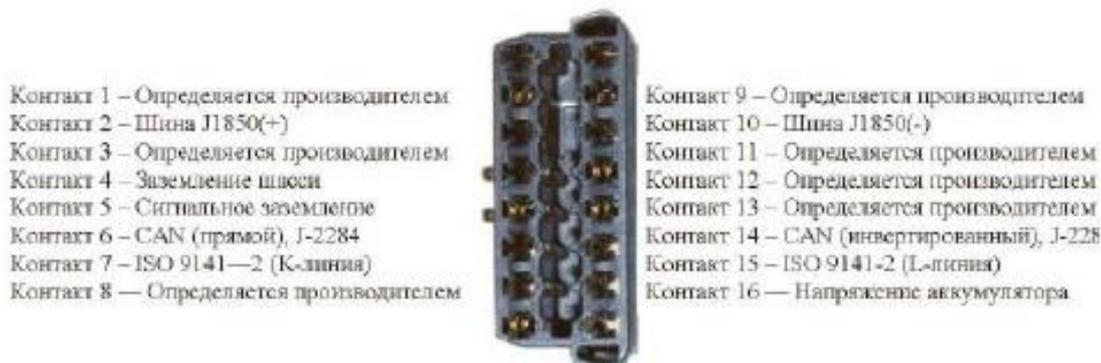
Рис. 6. Диагностический разъем OBDII
