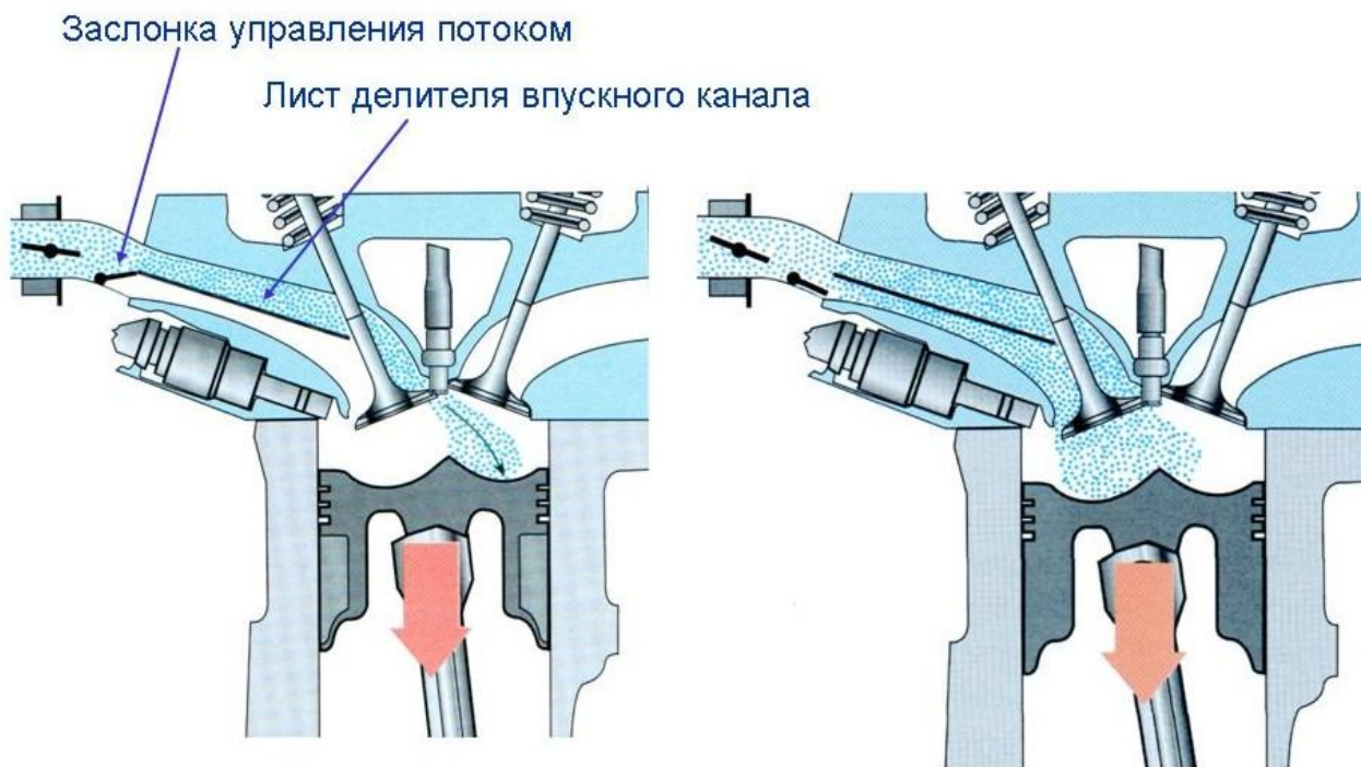
Рис. 13. Способы подачи воздуха в цилиндр двигателя
