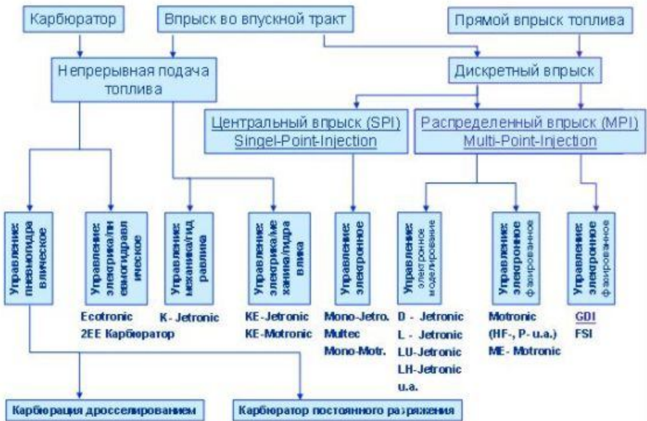
Рис. 2. Способы подачи бензина в ДВС
