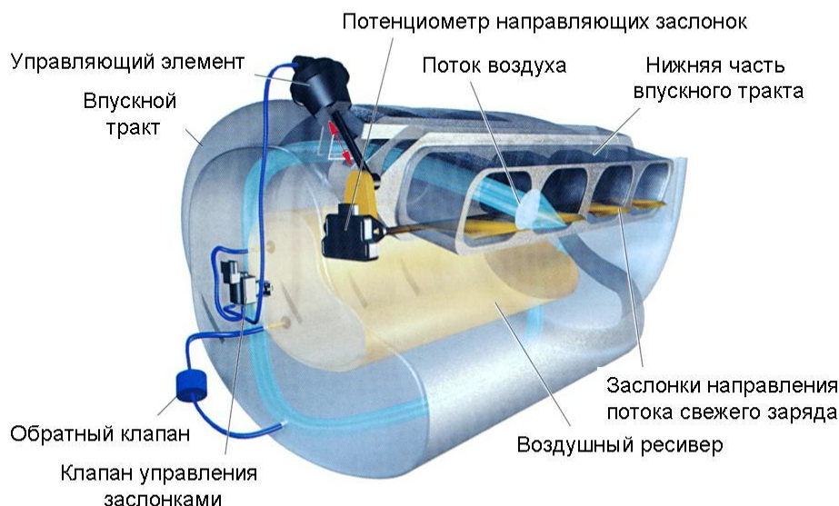
Рис. 11. Воздушный ресивер с элементами управления
