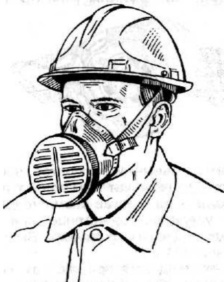
Рис. 3. Противопылевый респиратор Ф-62Ш
