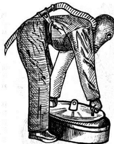
ПШ-2 обеспечивает одновременную работу в нем двух человек, для чего воздуходувка имеет два штуцера и два шланга. Если противогазом пользуется один человек, то к воздуходувке присоединяется один шланг, а штуцер для второго шланга закрывается заглушкой-колпачком. Сопротивление входу при работающей воздуходувке отсутствует.
