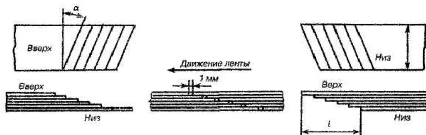
Рисунок 2.12 – Схема подготовки ленты к вулканизации
