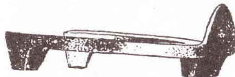
Рис. 98. Та же подкова с большим отворотом: виден захват, отодвинутый немного назад
