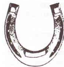
Рис. 101. Та же правая задняя подкова с нижней поверхностью. Сварка захвата произведена у внутреннего края подковы
