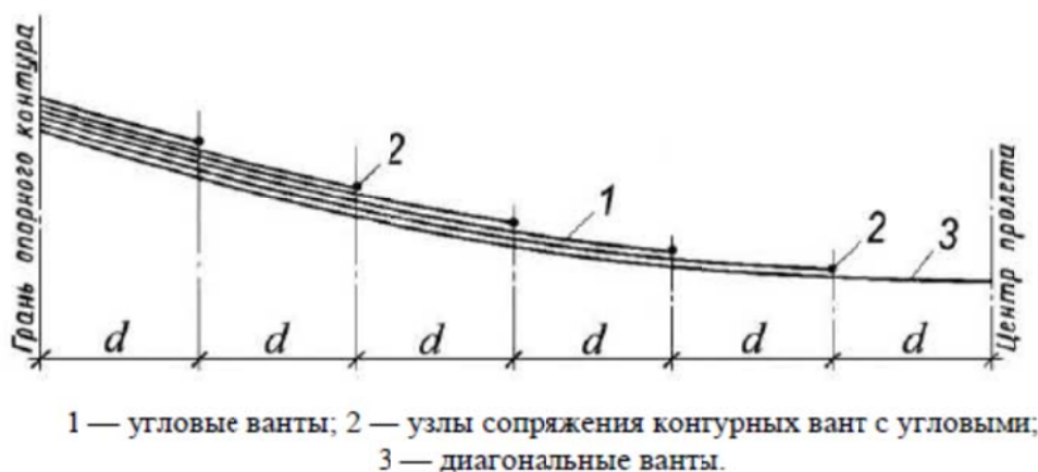
Рисунок 13.18. Расположение угловых вант полигонально-вантовой системы в вертикальной плоскости
