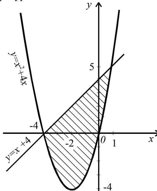
Площадь  $S$  фигуры, ограниченной сверху и снизу графиками функций  $y = f(x)$  и  $y = g(x)$ , пересекающимися в точках с абсциссами  $x = a$  и  $x = b$ , определяется по формуле  $S = \int_a^b (f(x) - g(x)) dx$ .
