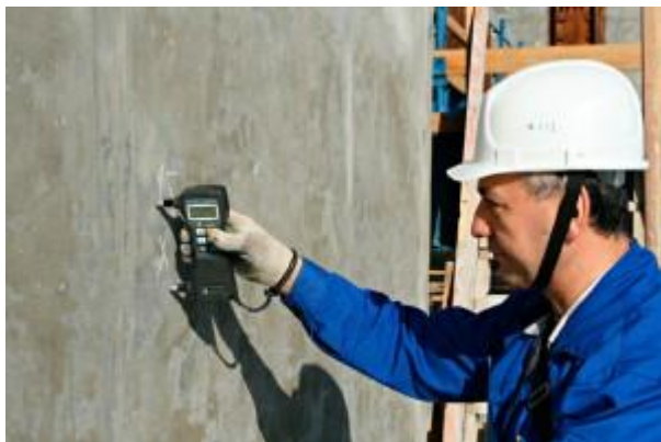
Способы ультразвукового прозвучивания бетона
