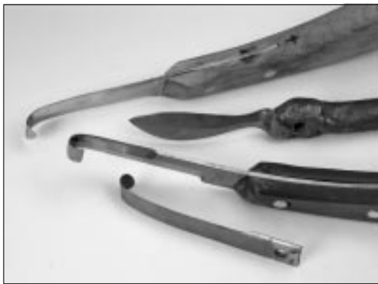
Рис. 4.22. Копытные ножи с самозатачивающимися лезвиями
