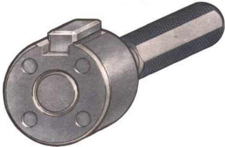
КОМПЛЕКСНЫЙ ПРОХОДНОЙ КАЛИБР-ПРОБКА для контроля паза втулки по размеру D+t_2
