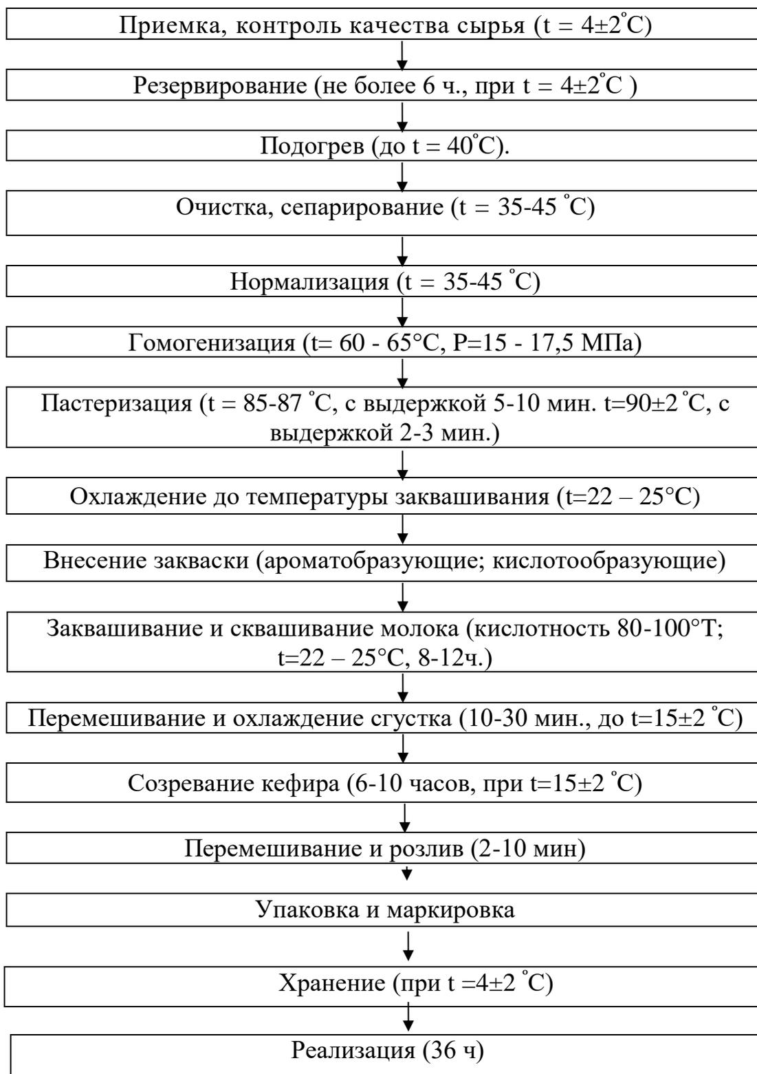
Рисунок 2.1 - Технологическая схема производства кефира [22]
