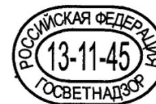
Клеймо овальной формы (размер 40×50 мм; ширина ободка 1,5 мм; высота букв 6 мм; высота цифр 12 мм)
