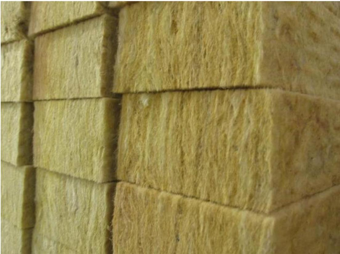
Минеральная вата (в зависимости от вида исходного сырья) может иметь различную структуру волокнистости, заданную технологически: горизонтально-слоистую, вертикально-слоистую, гофрированную или пространственную, что расширяет возможности её применения в тех или иных конструкциях.
