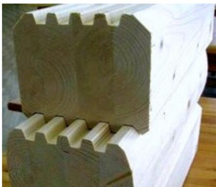
Производство клееного бруса производится составлением отдельных досок (ламели) в пакеты и склеиваются по плоскости. Изготавливается из древесины хвойных пород, преимущественно из ели. В России для производства клееного бруса, в основном, используются сосны и ели, реже — сибирские кедр и лиственница. В США, Канаде и Японии, клееный брус также производится из кедра и Дугласовой пихты.
