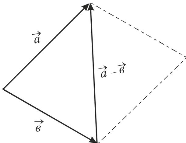
Рис. Построение вектора разности  $\vec{a} - \vec{b}$
