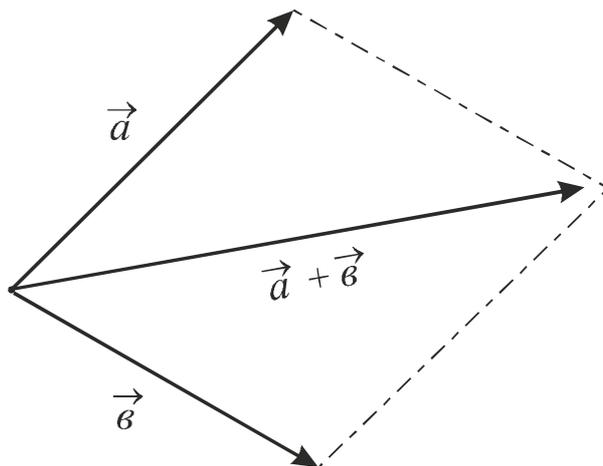
*Рис. Построение вектора суммы  $\vec{a} + \vec{b}$  по «правилу параллелограмма»*
