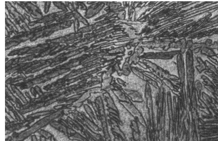
Микроструктура титанового сплава ВТ6 после закалки ( \times 400 )
