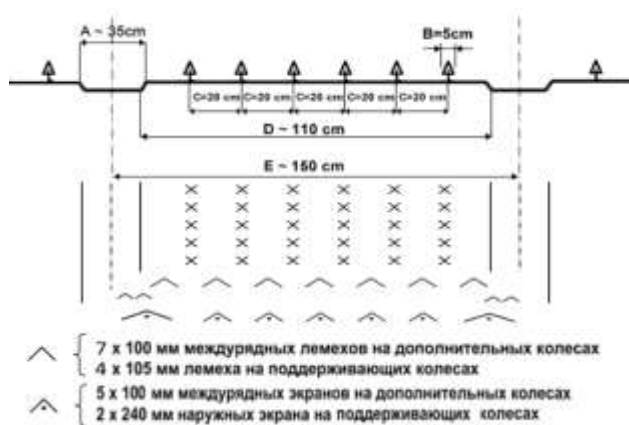
Рисунок 13 - Настройки культиватора и опрыскивателя по 6-ти строчной (рядной) схеме посева (посадки)
