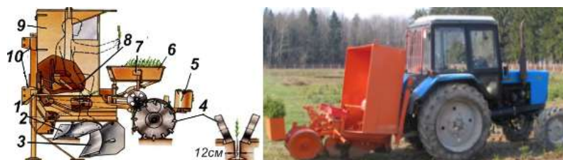
Рисунок 23 – Лесопосадочная машина ЛП-1 (МЛУ-1) 1 – рама; 2 – предохранительный нож сошника; 3 – сошник; 4 – уплотняющий каток; 5 – балластный ящик; 6 – ящик для семян; 7 – посадочный аппарат; 8 – место сажальщика; 9 – кабина; 10 – навесное устройство
