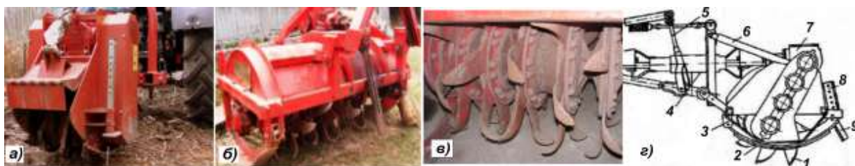
Рисунок 22 – Фрезерные орудия: а – ФС-045, в - ФЛУ-0,8; б ; 1 – ведомый диск с ножами; 2 – опорная лыжа; 3 – рама; 4 – карданный привод; 5 – навесная система трактора; 6 – навеска фрезы; 7 – редуктор; 8 – регулировочный кронштейн; 9 – гребенка
