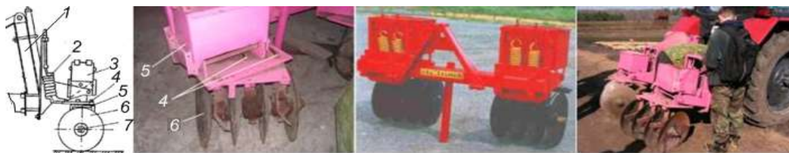
Рисунок 31 – Культиватор лесной бороздной КЛБ-1,7: 1 – рама; 2 – амортизационное устройство; 3 – балластный ящик; 4 – неподвижная плита; 5 – нижняя горизонтальная плита; 6 – батареи дисков; 7 – ось батареи
