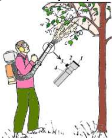
Рисунок 35 - Работа с опрыскивателем: 1 – насадка смесительной камеры; 2 – метка установки дозатора;
