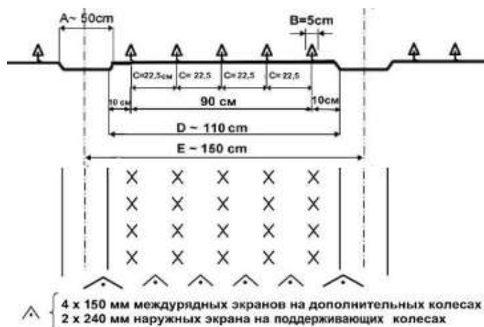
Рисунок 14 - Настройка опрыскивателя по 5-ти строчной схеме посева
