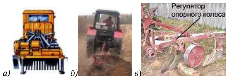
Рисунок 3 – Особенности работы гусеничного (а) и колесного (б) плужного агрегатов; в – механизм регулировки опорного колеса плуга
