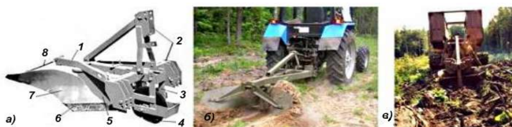
Рисунок 21 - Плуг лесной ПКЛ-70: а, б - основная комплектация; 1 – рама; 2 – навеска; 3 – кронштейн; 4 – дисковый подрезной нож; 5 – нож корпуса; 6 – лемех; 7 – отвал; 8 – распорка отвалов; в – комплектация с лапой для рыхления дна борозды
